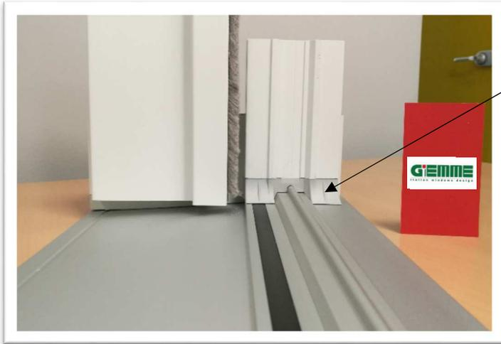
Fissare il terminale di gomma sul listello di battuta eliminando tramite taglio l'aletta pieghevole.
