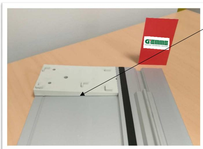
Fissare il tampone tramite siliconatura della parte inferiore facendo attenzione al centramento dei fori sulla soglia.
