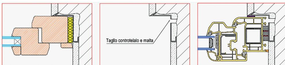
Il taglio termico del controltelaio metallico nella **posa in mezzaria**: situazione di partenza, dopo il taglio e dopo la posa del serramento
