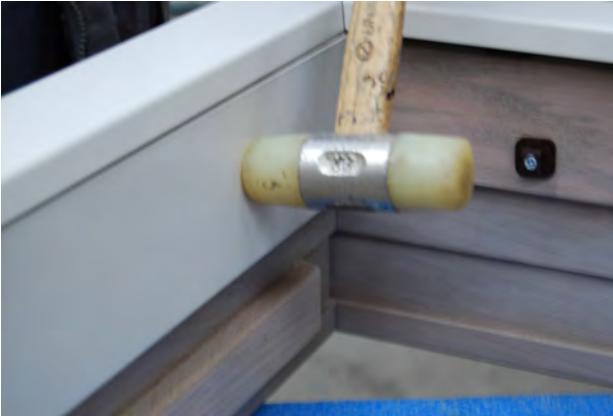
6. Fissare alle clips a scatto già montate battendo dolcemente sul carter senza ammaccarlo.
