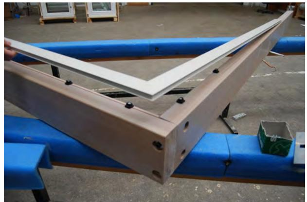
3. Quindi, una volta costruito il telaio adagiarlo sulle clips girevoli già montate.
