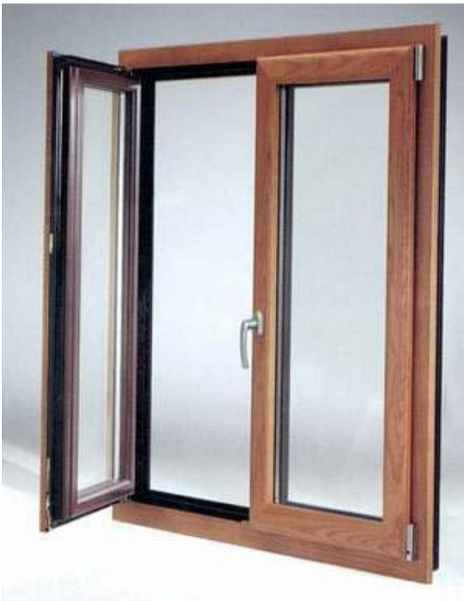
I serramenti prodotti vengono realizzati in legno lamellare composto da più lamelle perfettamente essiccate incollate con colla d3 formando un singolo travetto. L'impiego del legno lamellare assicura la realizzazione di un serramento di alta qualità, stabile e indeformabile nel tempo poiché le tensioni interne a ogni tavoletta, che tendono a deformarla, si annullano.
