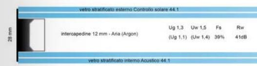
Massimo comfort e massimo risparmio energetico durante tutto l'anno. Versione che prevede l'utilizzo di vetrocamera con doppio vetro stratificato (interno ed esterno) e con rivestimento (coating) ad elevate prestazioni di isolamento termico e controllo solare. Permette normalmente di ottenere un isolamento acustico adeguato agli standard previsti dalle norme.
