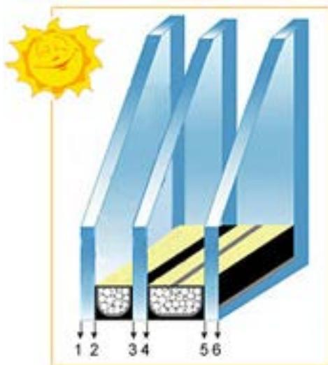
Può essere adattato a qualsiasi forma delle lastre (che possono anche essere circolari); data la flessione delle lastre sotto la spinta del vento, per vetrate di grandi dimensioni si utilizza un telaio che crei un'intercapedine di almeno 12 mm.
