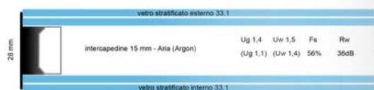
Massimo comfort e massimo risparmio energetico in inverno. Versione che prevede l'utilizzo di vetrocamera con doppio vetro stratificato (interno ed esterno) e con rivestimento (coating) basso emissivo ad elevate prestazioni di isolamento termico. Permette normalmente di ottenere un isolamento acustico adeguato agli standard previsti dalle norme.
